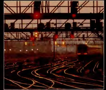
تصنع خطوط السكك الحديدية من الفولاذ المقوّى بالمنغنيز.
